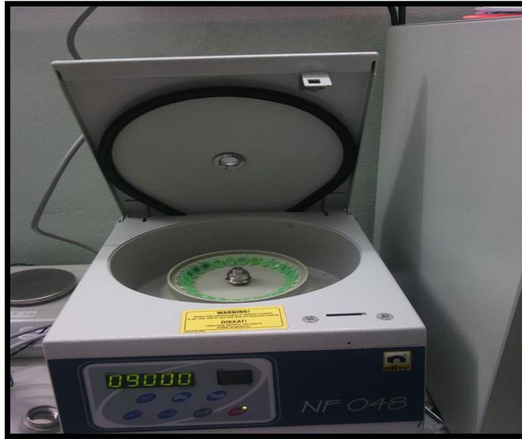
**Figure 5 :** Centrifugeuse à Eppendorff
