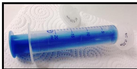
**Figure 13: Filtre seringue de 0,22 µm**
