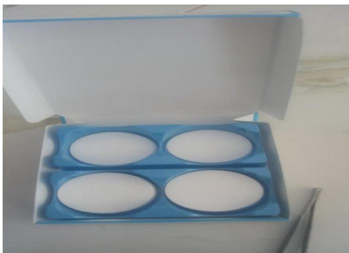
Figure III.23: les filtres de MES dans les points de prélèvement
