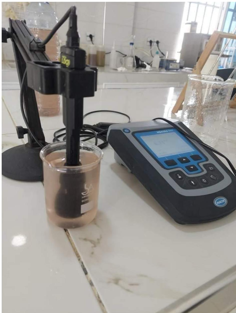
Figure III.21: Mesure de la conductivité électrique, salinité et température
