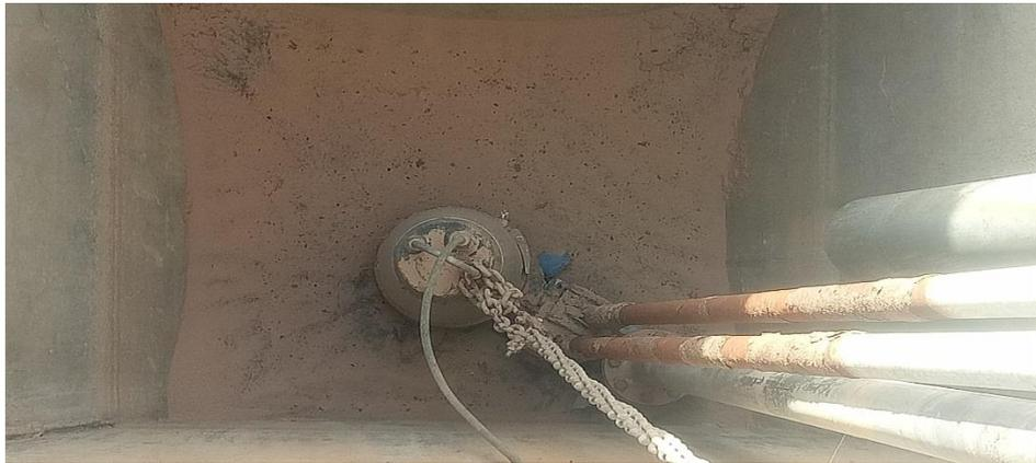
**Figure III 8: une pompe d'aspiration (eau +sable )**
