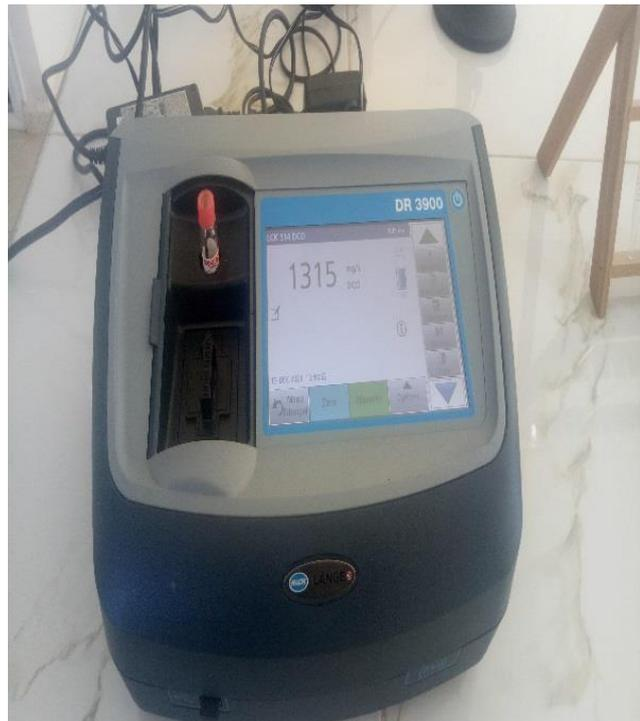
Figure III.29.: Spectrophotomètre DR3900
