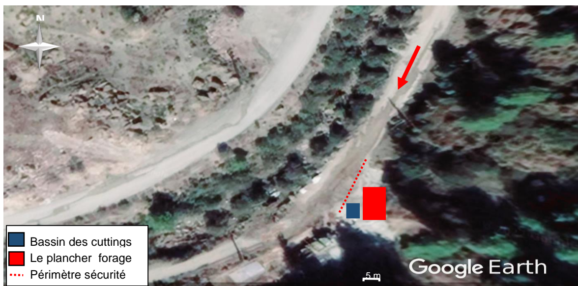
Figure III.12 : Plan d'installation du chantier pour le battage.
