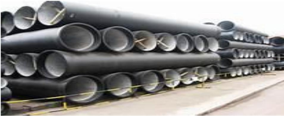
**Figure IV.15 :** Conduite en fonte ductile.
