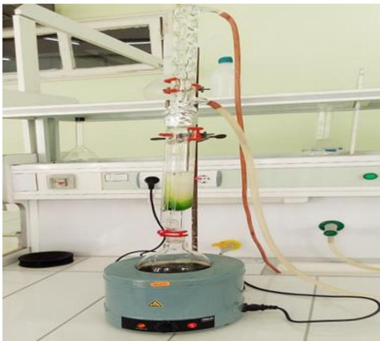
**Figure II.3.** Montage expérimental de l'extraction par soxhlet
