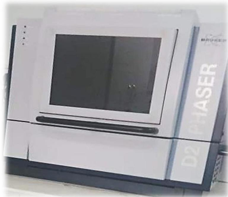
**Figure II.3.** Diffractomètre de rayon X- D2 PHASER.
