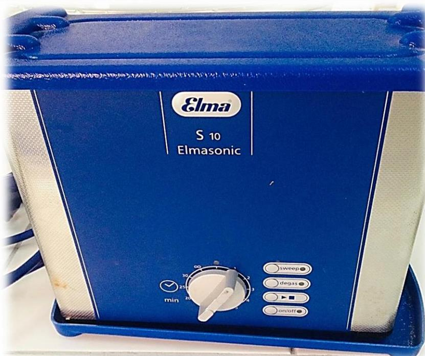
**Figure II.4.** Sonicateur ELMA S10 Ultrason.
