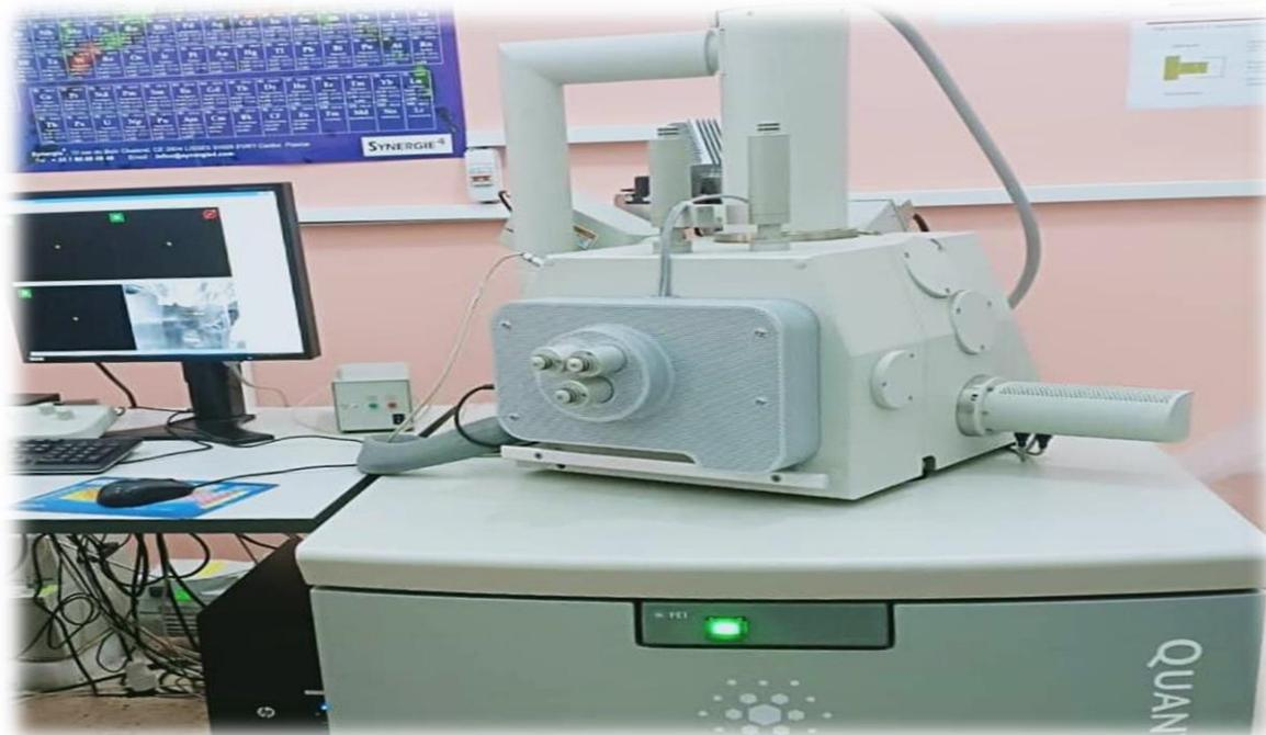
**Figure II.5.** Microscope électronique à balayage QUANTA 650.
