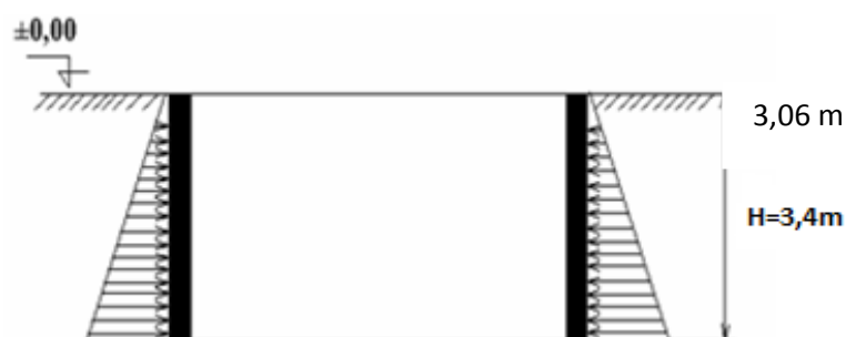
Figure VI . 9: Poussées des terres.
