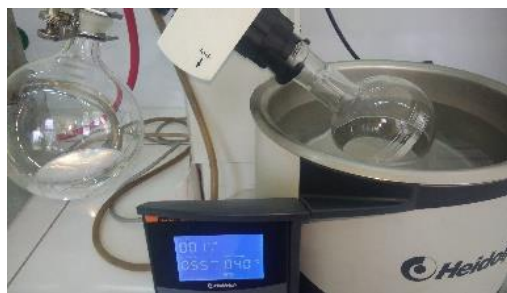
Evaporation sous vide de l'acétate d'éthyle recueilli 40°C
