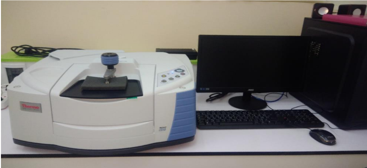
Figure 6 : spectromètre IR-TF Thermo Scientific™ Nicolet™ iS™10.
