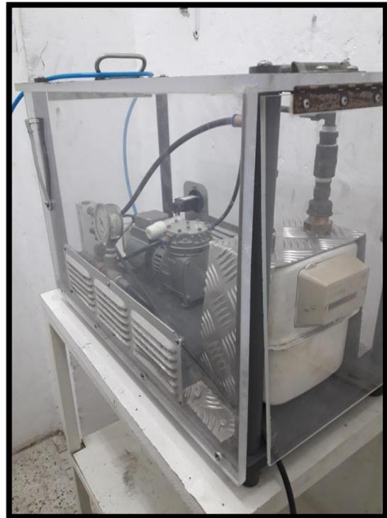
Figure II.1.2 : L'échantillonneur Gent Sampler.
