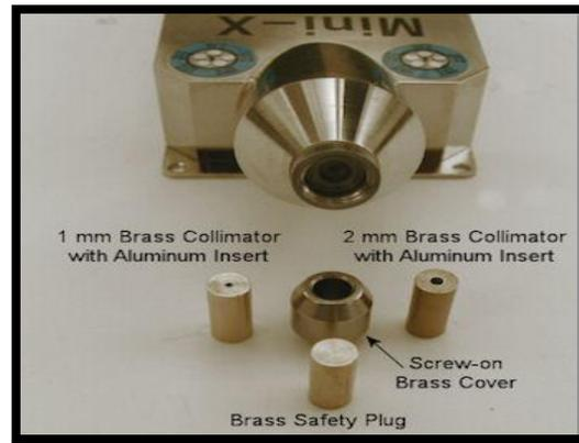
Figure II.4.5 : Cette photo montre les deux collimateurs (Mini-X), le bouchon de sécurité et le capot.
