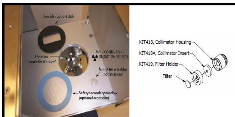
Figure II.4.4 : Image de la fenêtre de détection du dispositif expérimental (Amptek Ink). [55]
