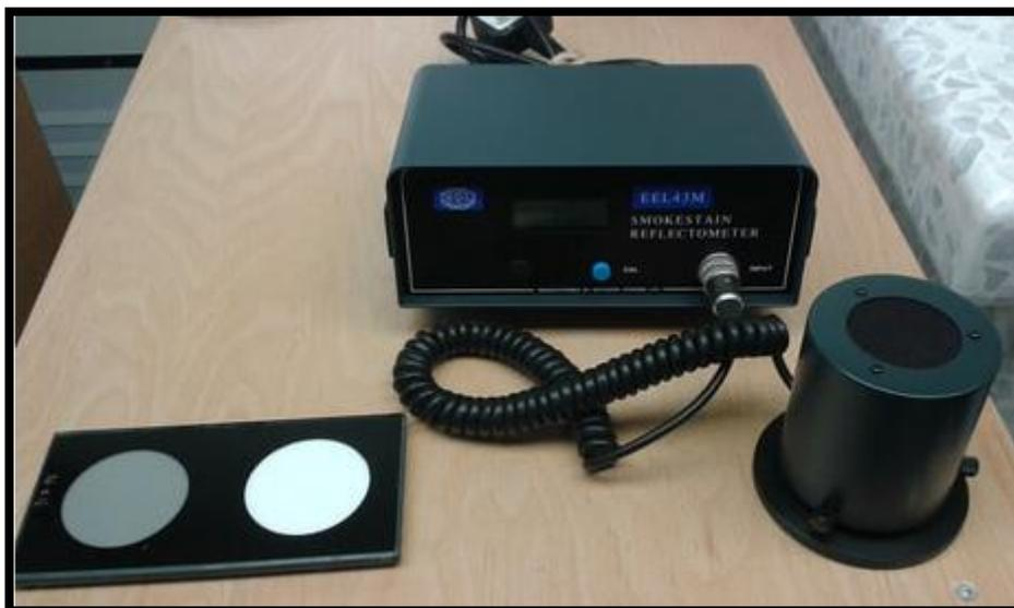
**Figure II.2.1** : Réflectomètre de fumée.
