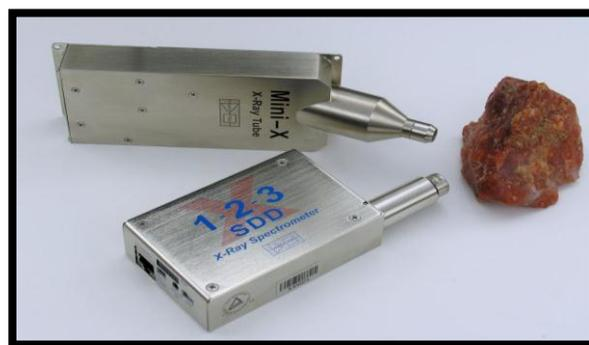
Figure II.4.3 : Spectromètre complet X-123 avec Super SDD (fenêtre 25 mm<sup>2</sup> / 500 µm, 0,5 mil Be) et un tube à rayons X (USB Mini-X).
