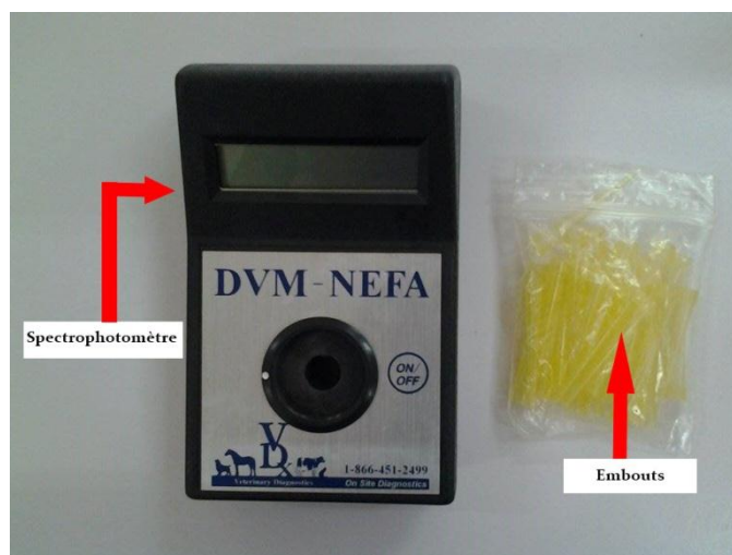
Figure VI.1 : DVM-NEFA pour le dosage des acides gras non estérifiés
