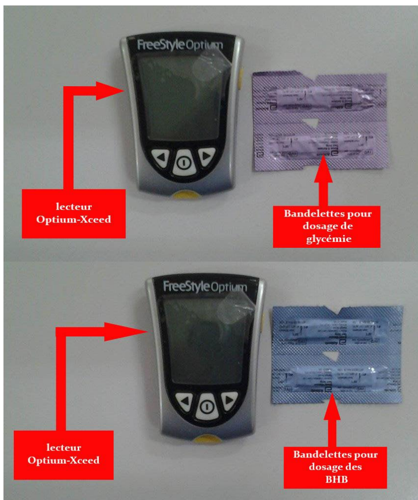
Figure VI.3 : Lecteur OPTIUM EXCEED pour dosage de glucose et des BHB.
