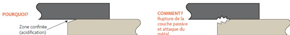
Figure II.2 : corrosion caverneuse
