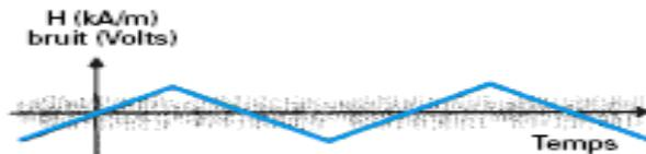
Figure III.6 : Description partielle de processus d'aimantation
