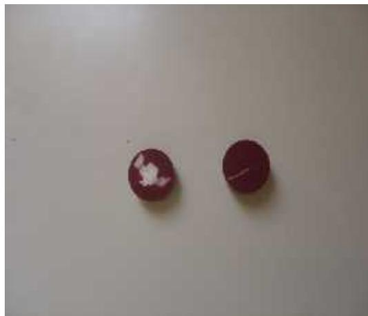
**Figure II.12 :** Talons de soudure enrobée par la résine d'une épaisseur 2 mm.
