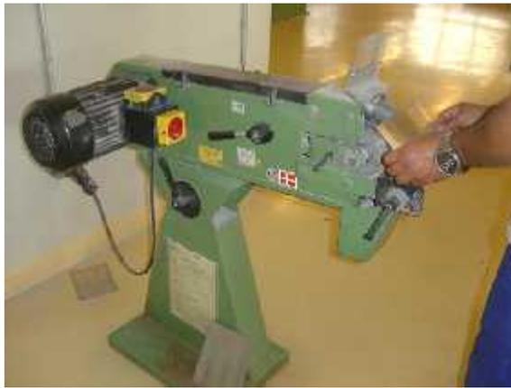
**Figure II.2 :** Préparation de chanfrein de forme V.
