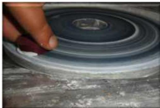
**Figure II.15 :** 2<sup>ème</sup> Etape de Polissage (Finition).
