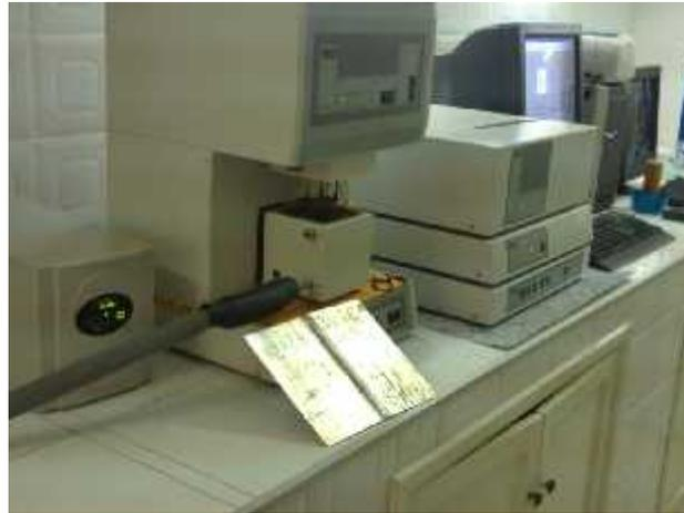
**Figure II.26 :** L'analyseur mécanique dynamique (AMD) 242 C de la société NETZSCH.
