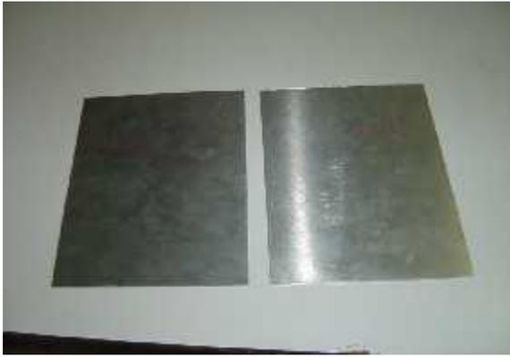
**Figure II.5 :** Plaque d'aluminium 2024 T351 (Epaisseur = 2 mm).
