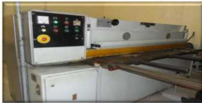
**Figure II.1 :** Machine de Guillotine.
