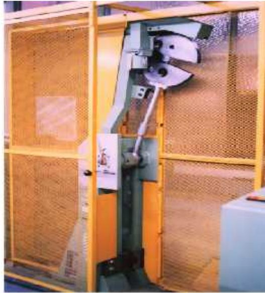
**Figure II.22 :** Pendule mouton Charpy PSW.
