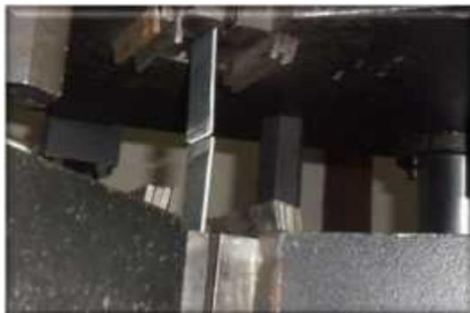
**Figure II.20 :** Eprouvette au cours d'un essai de Traction.
