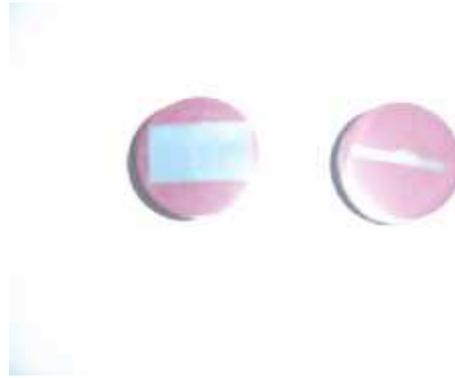
**Figure II.16 :** Après polissage le cordon de soudure enrobé par la résine d'une épaisseur de 2 (mm).
