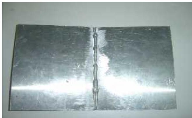
**Figure II.10 :** La penetration de la soudure sur la plaque.
