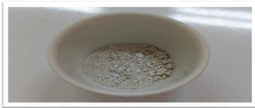
Figure II.10 : Résidu de composé minéraux qui reste après l'incinération à 525 C° dans le four à moufle d'un échantillon du mucilage.
