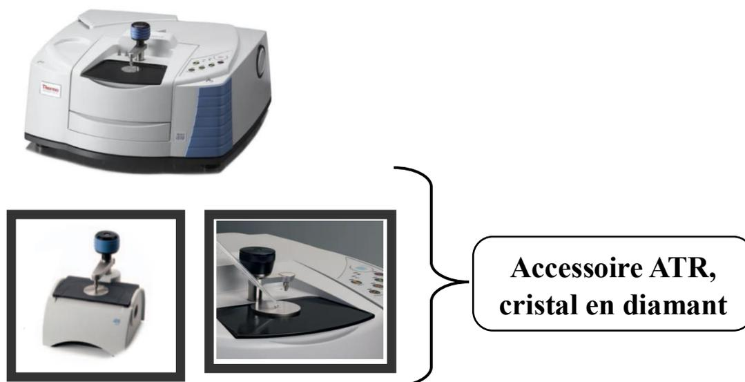
Figure II.5 : Spectromètre IRTF, modèle Nicolet iS10 FT-IR spectromètre Thermo Scientific
