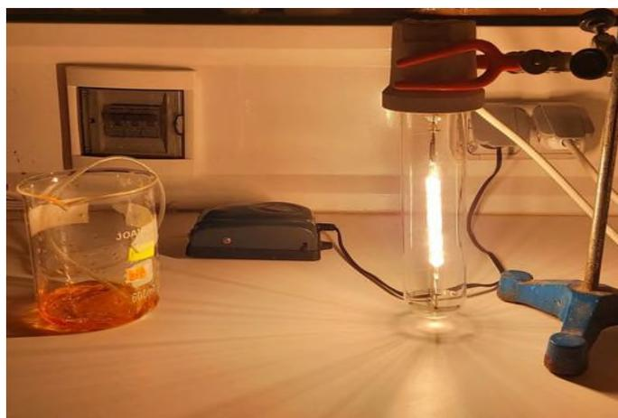
**Figure II.18 :** Photo représente le mode d'exposition à la lampe visible du sodium à pression 500watts
