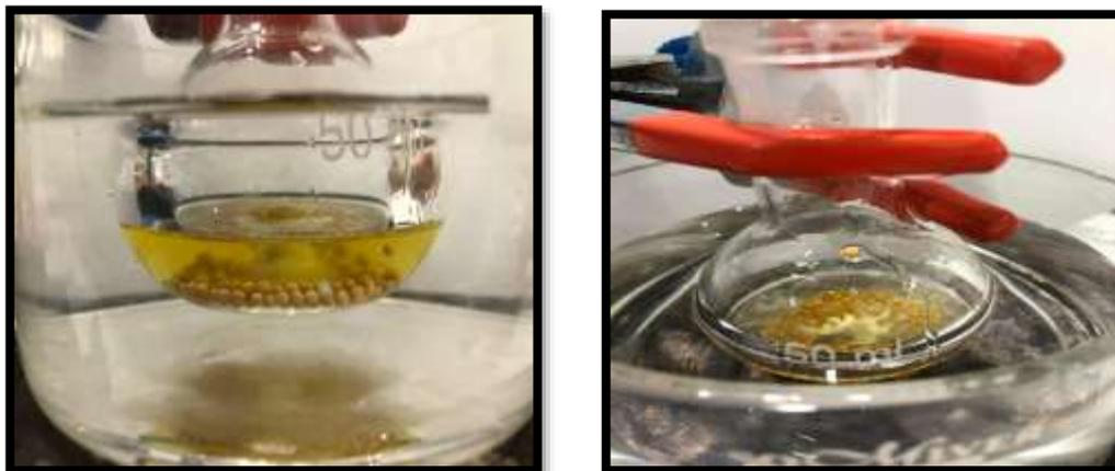
**Figure 2.6.** Réaction d'estérification sous agitation magnétique.
