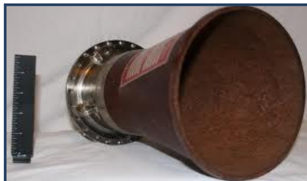
Fig. (I.2) : tuyère conique
