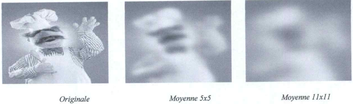
Figure II.4 : Exemple de filtre moyenne [R8]
