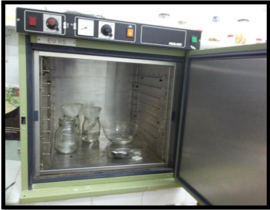
Figure 2 : étuve (photo original 2018)
