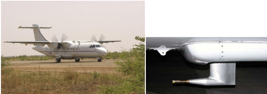
Figure 2.11 : L'ATR 42 au sol avant le décollage à Niamey (à gauche) et Veine AVIRAD de prélèvement (à droite).
