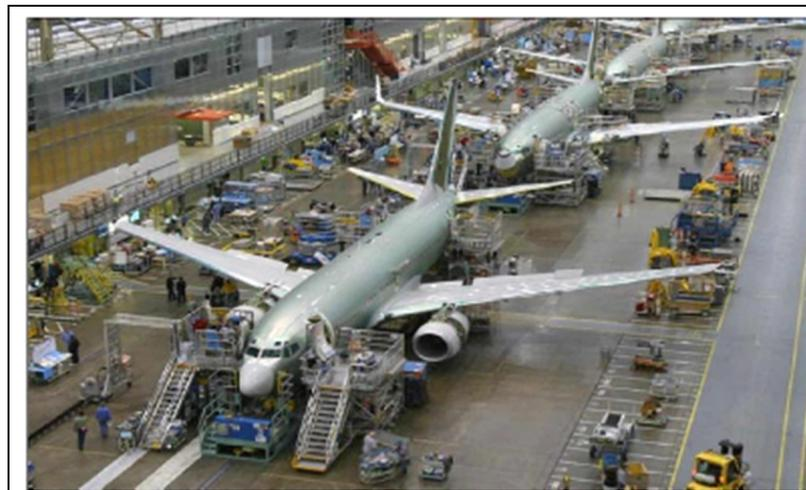
**Figure (2.2.3) : Production des B737 nouvelles générations**
