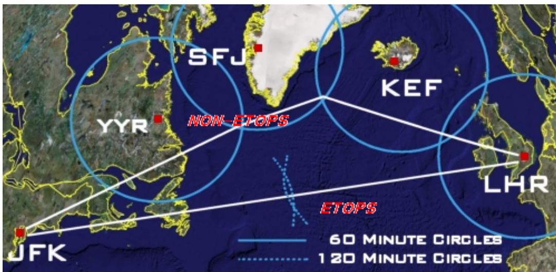
Figure I.1 : zone ETOPS et non-ETOPS
