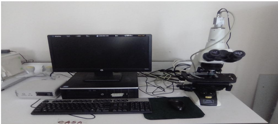
Figure 9 : photo d'un analyseur de sperme assisté par ordinateur (CASA) SCA® (photo personnel)
