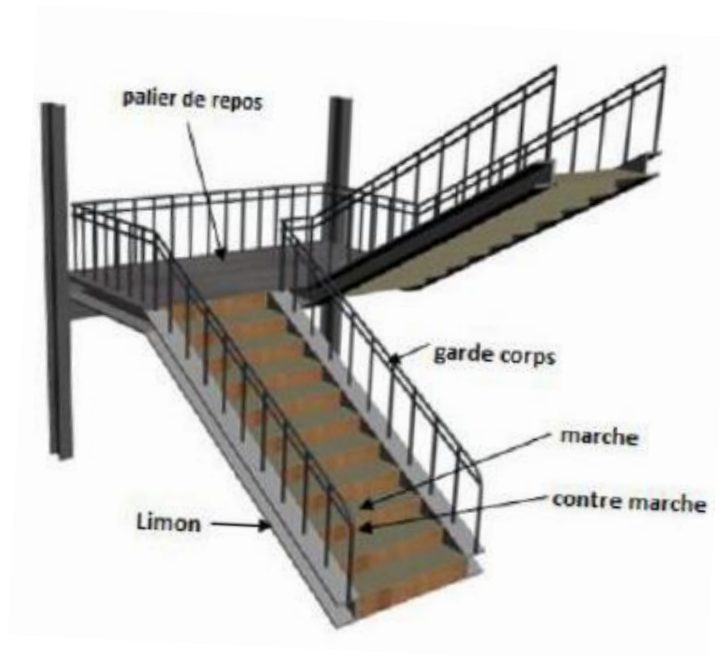
Figure IV. 5: Constituant d'un escalier
