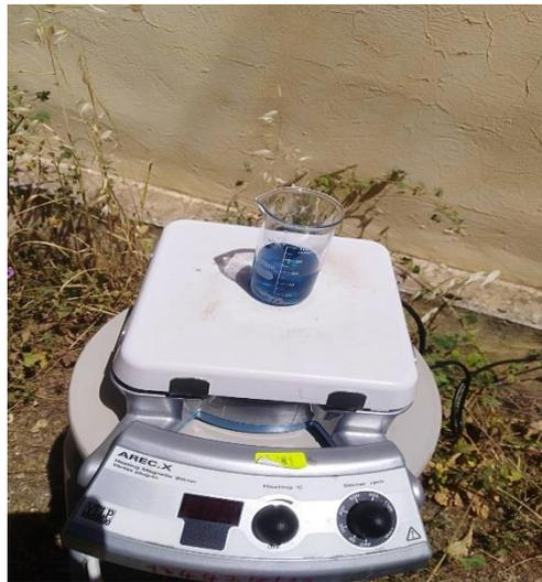
**Figure III.10:** exposition de solution au rayons solaire avec agitation
