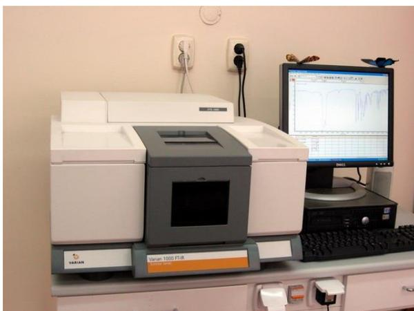
**Figure III.7:** spectroscopie infrarouge (FTIR)
