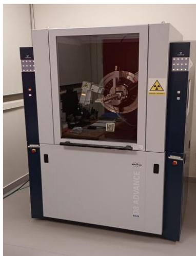
**Figure III.8 :** diffractomètre
