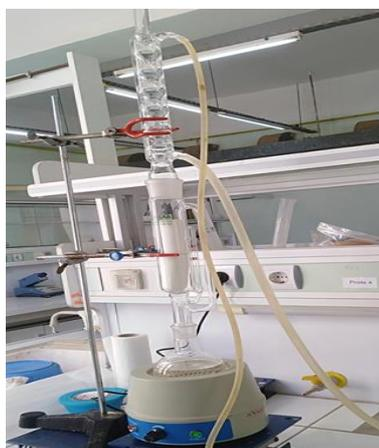
**Figure III.2 :** Montage d'extraction au Soxhlet
