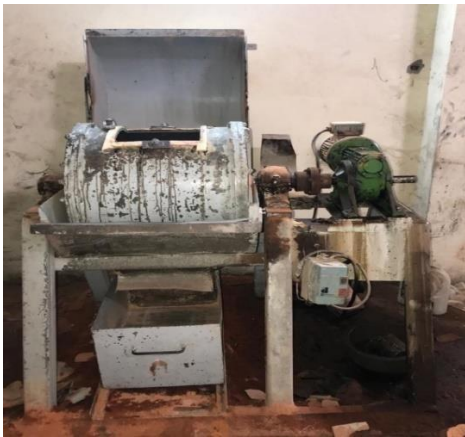
Figure II.1: Présentation d'un broyeur à boulet, (a) broyeur à boulets, (b) boulets en acier
