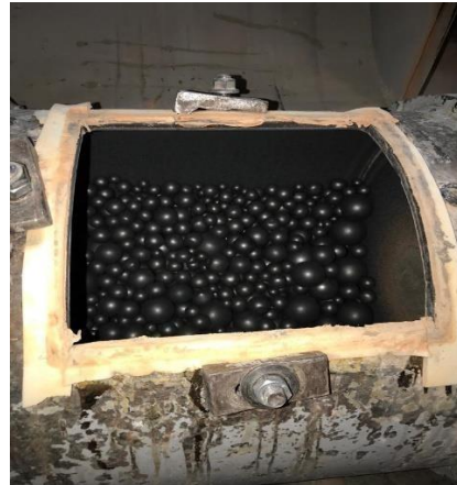
Figure II.1: Présentation d'un broyeur à boulet, (a) broyeur à boulets, (b) boulets en acier
