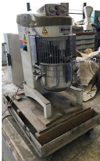
Figure II.8: Malaxeur de mortier
