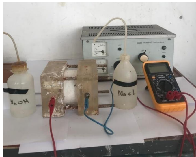
Figure II.10: Essai de la résistance à la pénétration des ions chlorures
