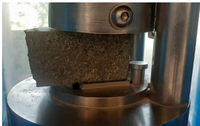
Figure II.6: éprouvette fissuré placé dans le dispositif de l'essai de compression
