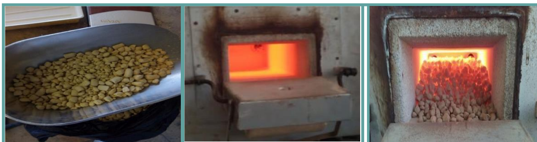
Figure I.13 : Processus de calcination flash du kaolin.
