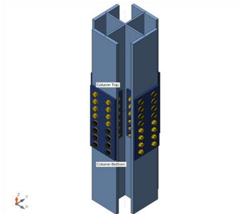
**Figure VI. 7: Vue de l'assemblage poteau-poteau**
