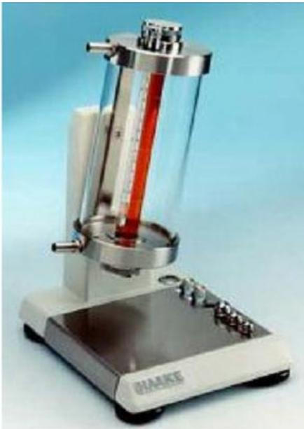
Figure (1.2) : viscosimètre de type Couette [13]
