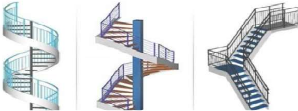
Figure I. 7: Escaliers en charpente métallique.
