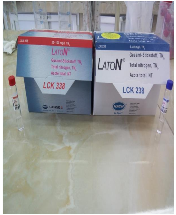
Figure.8 : Kit Hach LCK 338 et 238 (pour le dosage d'Azote total)
