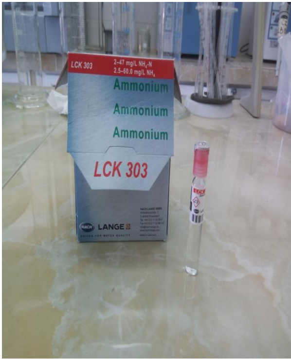
Figure .7 : Kit Hach LCK 303 (pour le dosage d'ammonium)
