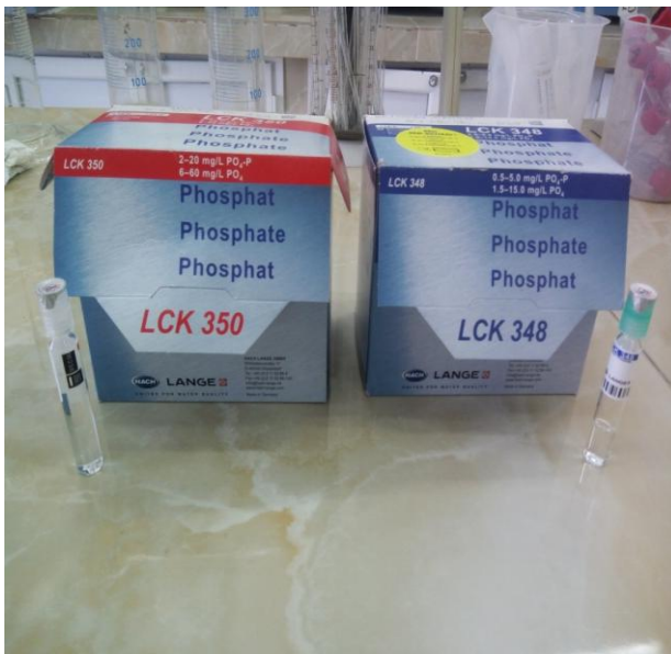
Figure.9 : Kit Hach LCK 350 et 348 (dosage du phosphate total)
