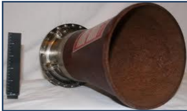
Fig. (I.1) : Tuyère Conique
