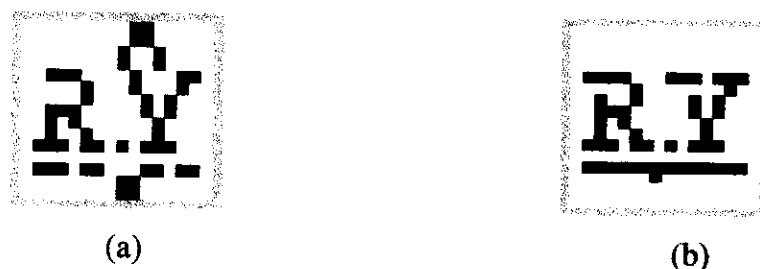
Figure V.12 Marques extraites de la vidéo « container » après le transcodage : (a) basée sur la méthode de DCT 4×4 et (b) basée sur la méthode de quantification
