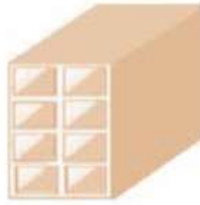
Figure I.3 : Cloison de séparation de 10 cm.
