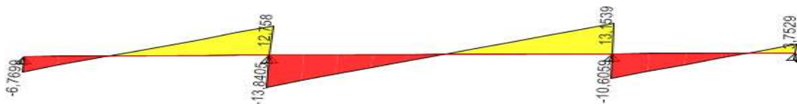
Figure. III.16: Effort tranchant de la poutrelle à 03 travées
