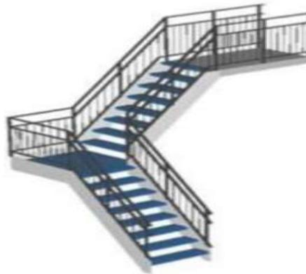
**Fig I.9:** Escalier en charpente métallique.
