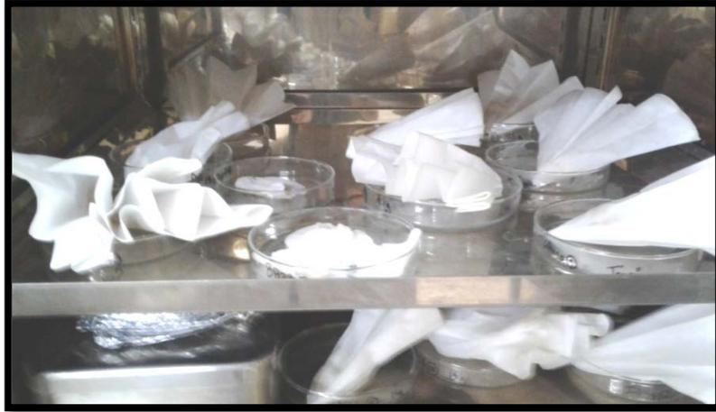
**Figure 8 :** Séchage des souches fongiques dans le four Pasteur.
