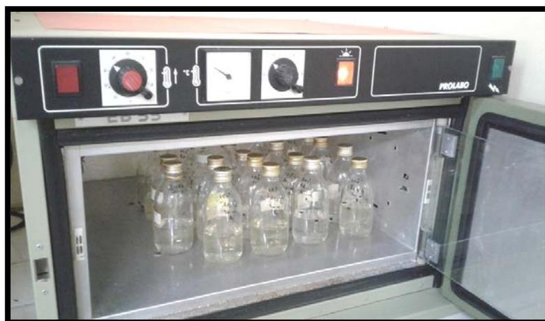
**Figure 10 :** L'emplacement des flacons contenant les souches testés dans une étuve réglée à une température de 45 °C.
