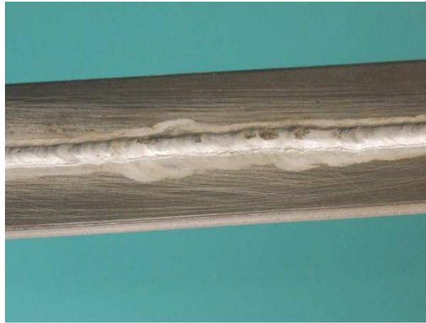
**Figure II.12 :** Apparition d'une fissure lors du soudage TIG d'un alliage D'aluminium 7075 T6 (épaisseur = 2 mm)
