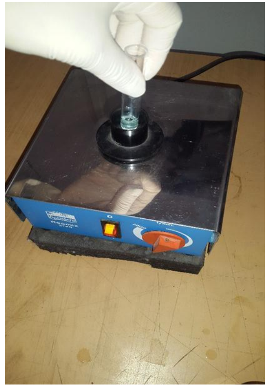
Figure19 : mélange des réactifs avec l'échantillon à l'aide d'un agitateur
