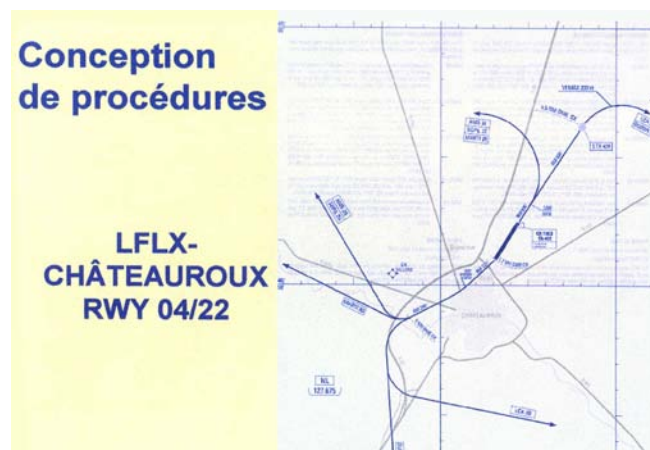
Fig.IV.2 : Procédure de départ pour l'aéroport de CHÂTEAUROUX
