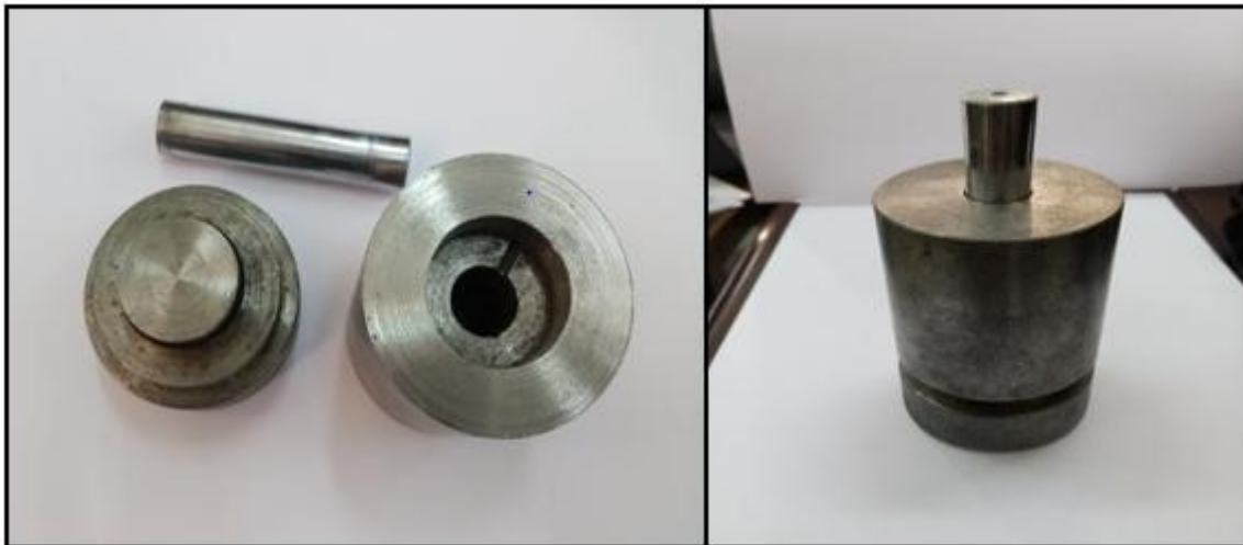
Figure 32 : Dispositif de compactage des poudres.
