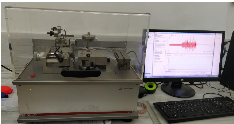
Figure 40 Tribomètre de type CSM, Suisse, Anton Paar TRB3.
