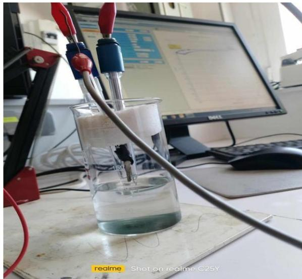
**Figure II.17 :** La cellule électrochimique.
