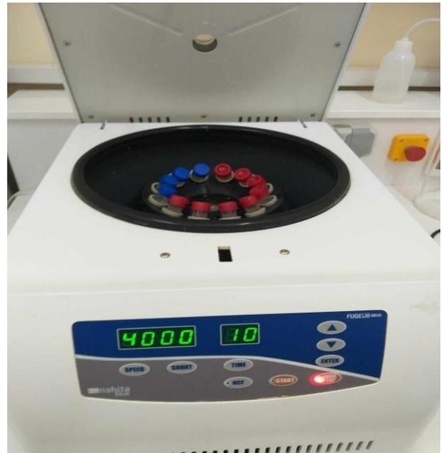
**Figure II.3 :** Image représente le lavage de montmorillonite avec la centrifugeuse.
