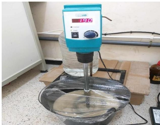
**Figure II.1** : Image représenté l'agitateur mécanique.
