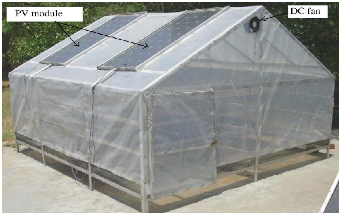
Figure I.16. un système hybride photovoltaïque sous un effet de serre [19]
