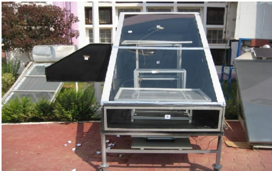
Figure IV.2 Photo de la serre après l'emplacement des thermocouples
