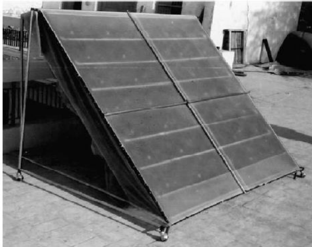
Figure I.13. le séchoir solaire étudié par Singh et al [3]
