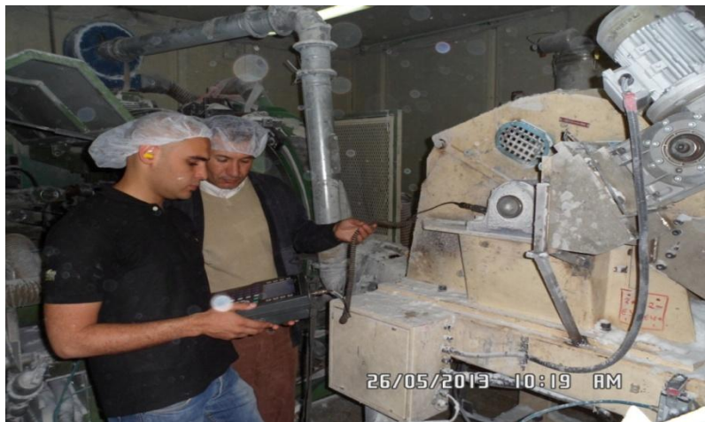
Photo 4-5 prise de mesure des vibrations du déchiqueteur
