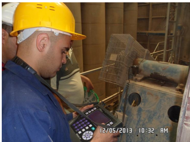
Photo 4.4 Enregistrement des mesures de vibrations du ventilateur
