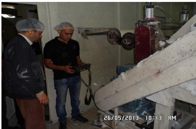
Photo 4-7 Enregistrement des mesures des vibrations du déchiqueteur
