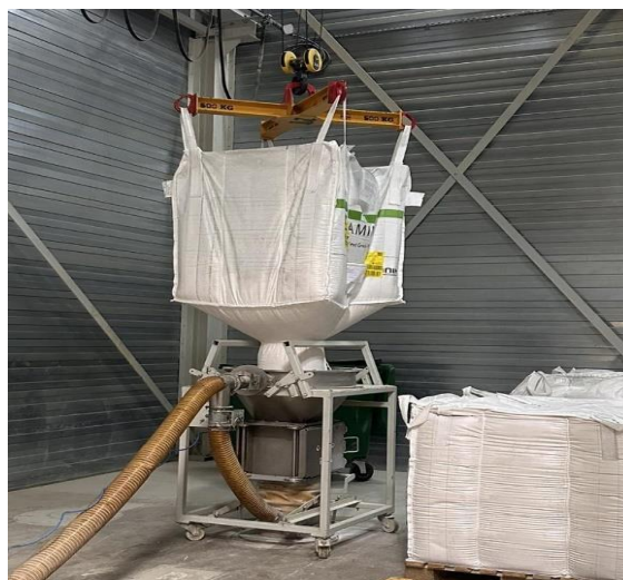
Figure 22. Dépotage d'un big bag dans la zone de dépotage (réalisée par l'étudiante)
