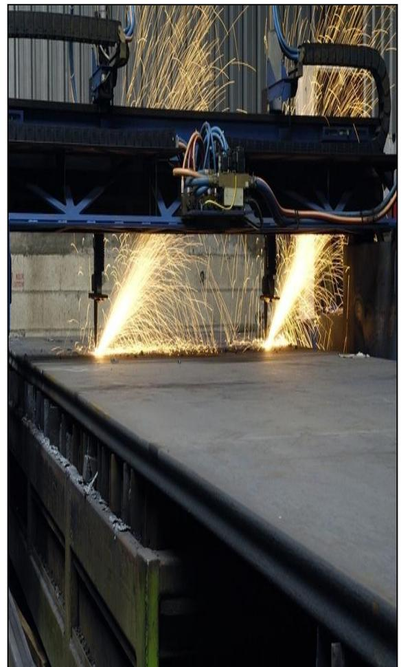
Figure IV.1 L'opération de l'oxycoupage CR-METAL
