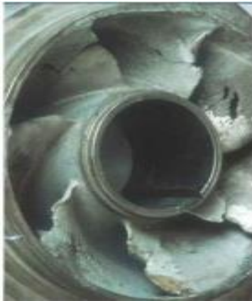
Figure I-2: Érosion par cavitation d'une roue de pompe centrifuge.
