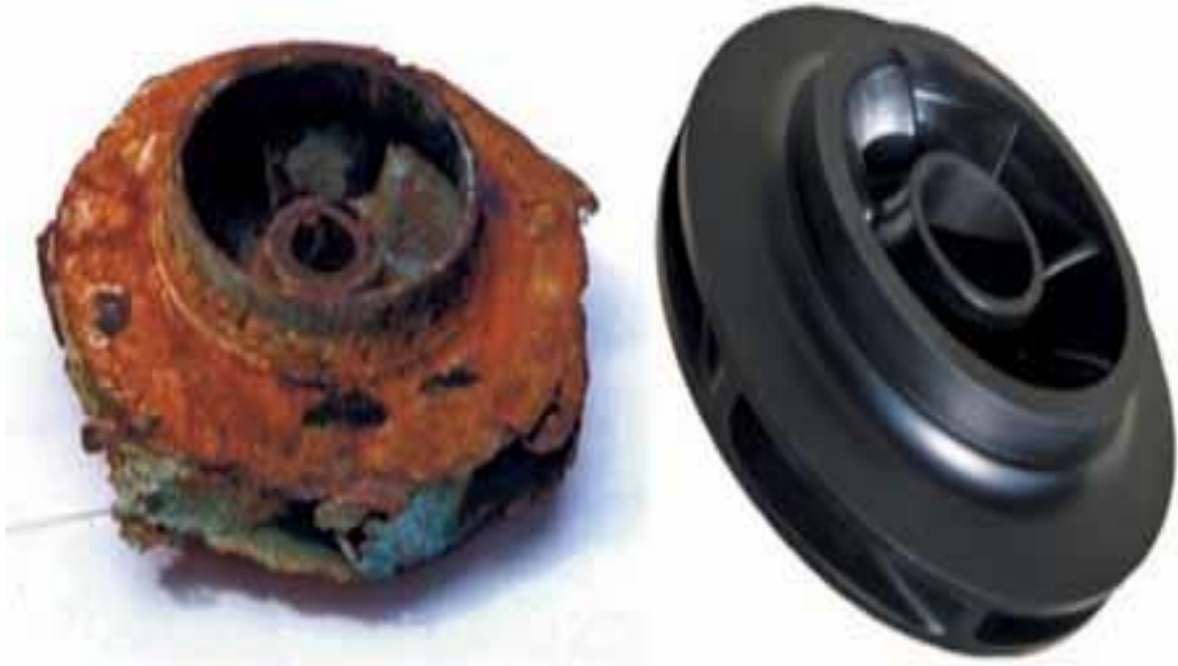
Erosion de la roue NVA
