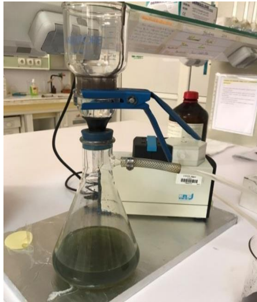
Figure 4.4 : Dispositif pour l'élimination des fragments métalliques par lixiviation acide.
