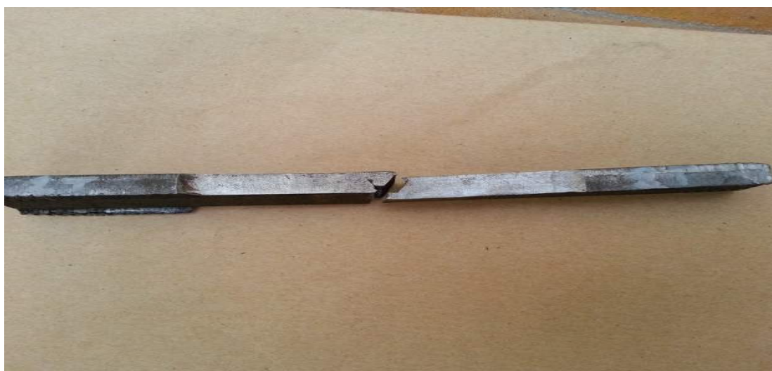
Figure V. 13 : l'éprouvette préchauffée P2 après rupture
