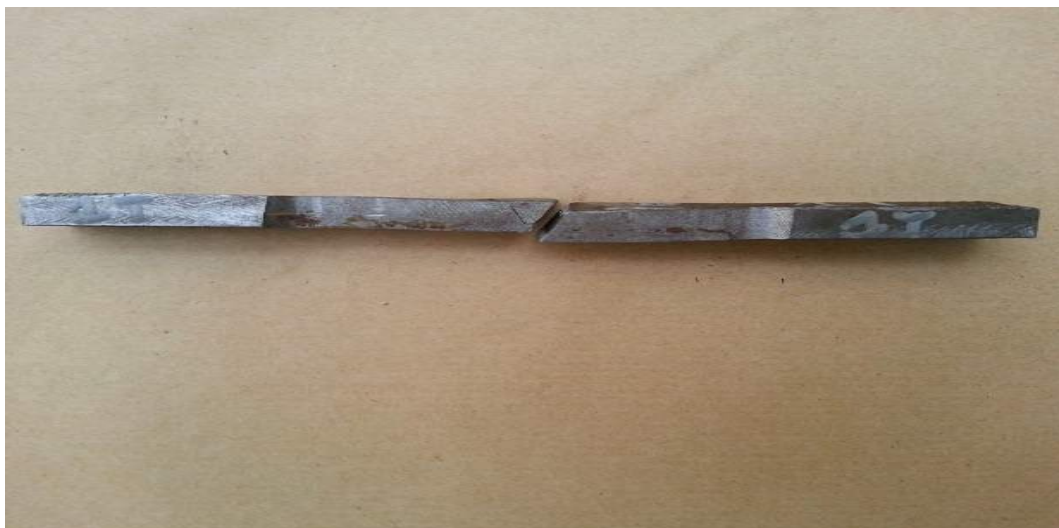
Figure V. 11 : l’éprouvette préchauffée P1 après rupture
