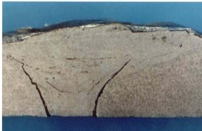
FigureII. 3 : Fissure à froid détecté en macrographie.[14]
