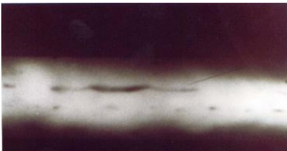
FigureII. 5 : Inclusions de laitier décelées par radiographie.[14]
