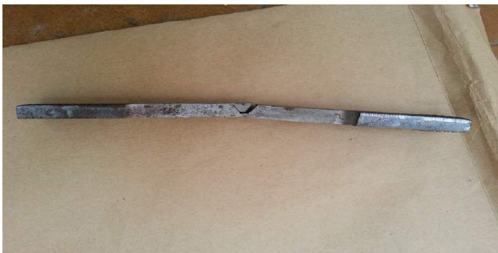
Figure V. 15 : l'éprouvette préchauffée P3 après rupture.
