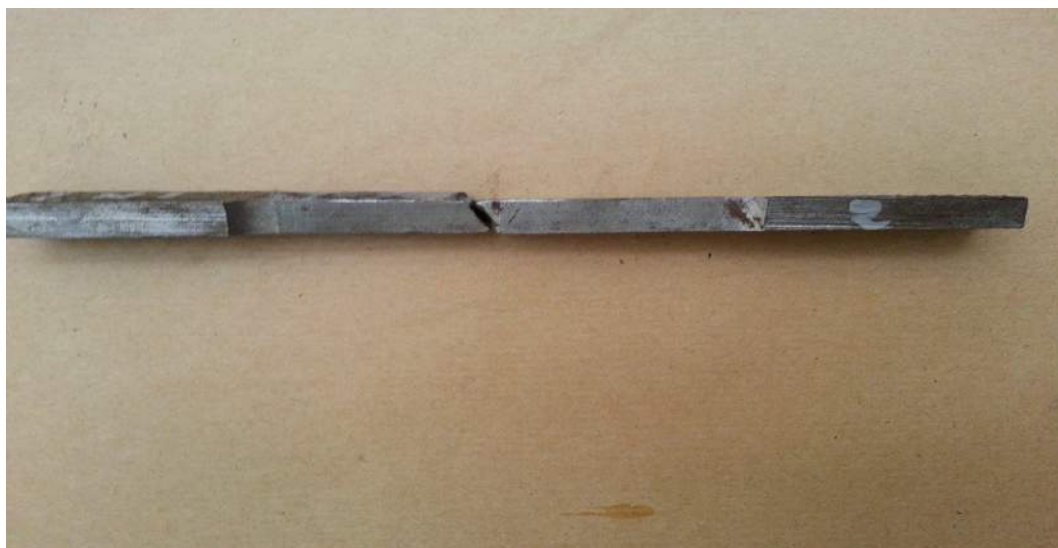
Figure V. 9 : l'éprouvette non préchauffé NP2 après rupture
