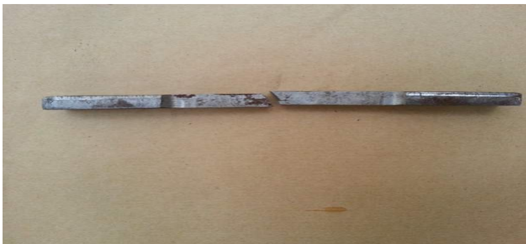
Figure V. 7 : l'éprouvette non préchauffé NP1 après rupture
