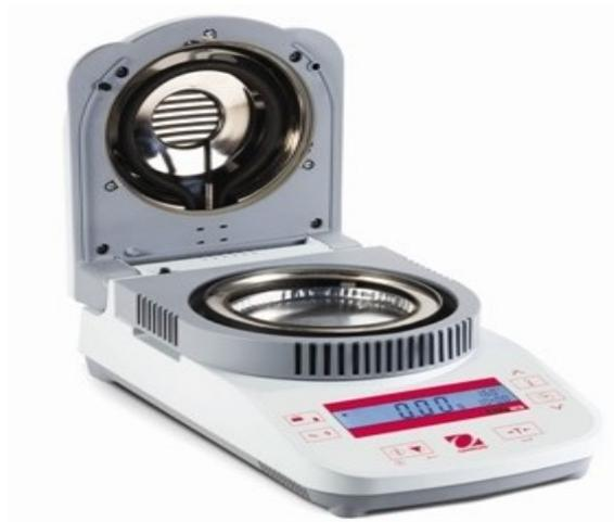
**Figure II.22 :** dessiccateur infrarouge.
