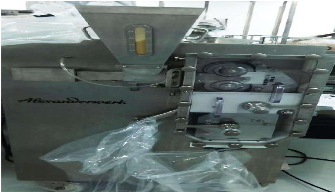
**Figure I.3:** La presse à rouleaux ou compacteur.
