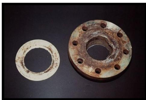
**Figure 1.4 :** figure présente la corrosion sous contrainte.
