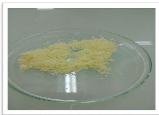
**Figure2.6** :la base de Schiff 1,3-bis (2-hydroxy benzylidène) urée.
