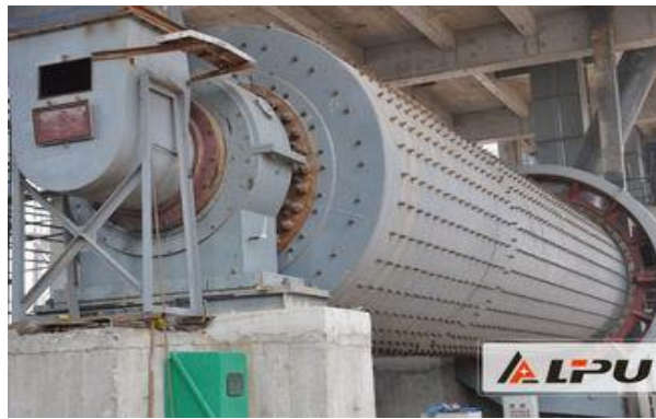
Figure I.6. Broyeur à boulets duc ru de la cimenterie
