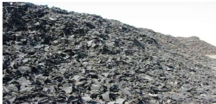
Figure I.1. Pneus grossièrement déchiquetés [6]
