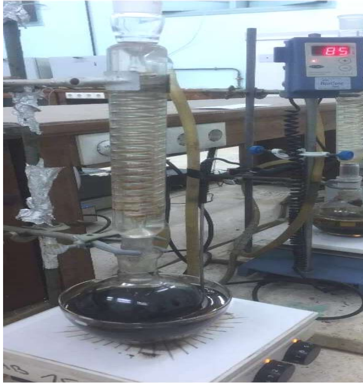
Figure II.2 : Dispositif expérimentale de l'imprégnation du précurseur (pneu) de D=300\mu\text{m}
