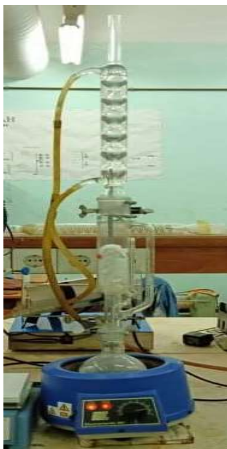
Figure II.4 : Lavage d'un charbon actif à l'aide d'un soxclet avec l'eau distillée
